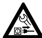
Irrota verkkopistoke pistorasiasta aina ennen laitteen huolto- yms. töiden aloittamista.
