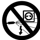
Elektriske anlæg, tilslutninger og strømførende ledninger må ikke renses med højtryksstrålen eller vandslangen – **fare for kortslutning!**
