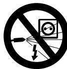
Älä suuntaa vesisuihkuja sähkölaitteisiin, liittimiin äläkä sähköjohtoihin. **Oikosulkujen vaara!**
