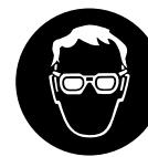
For at reducere faren for øjenskader skal der bæres tætsiddende sikkerhedsbriller iht. standarden EN 166. Sørg for, at sikkerhedsbrillerne sidder korrekt.
